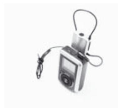
**Paso 5:** introduzca la clavija del micrófono en el conector del T20/T21.
