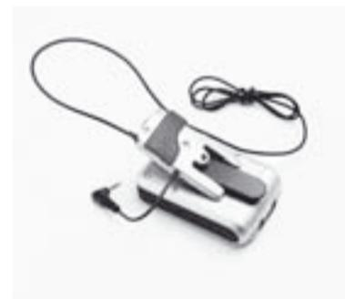
**Paso 3:** deslice el micrófono lavalier sobre el T20/T21 hasta la parte superior.
