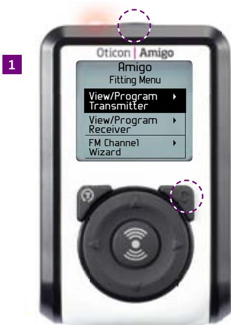
Los transmisores FM de Amigo T30 y T31 se pueden llevar con el colgador alrededor del cuello o sujetos a la ropa con el clip. Cualquiera de estos dos transmisores sirve de unidad de programación de Amigo Star y no requiere ningún otro dispositivo.
