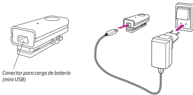
Para cargar la batería, conecte el cable de alimentación al conector mini USB situado en la parte inferior del micrófono.
